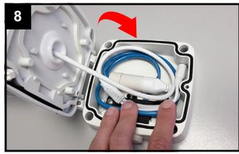
8 Verkabelung vollständig in die Anschlussbox legen und Deckel schließen.
