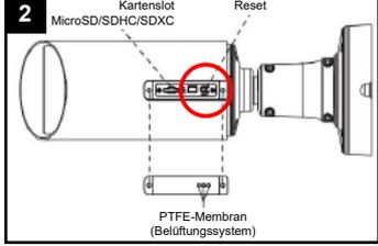
Derunter befinden sich Reset-Taste und Kartenslot. Für Reset: Fünf Sekunden lang die Taste gedrückt halten.
