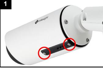
Schrauben an unterer schwarzer Abdeckung lösen.
