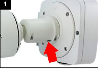
Die hier markierte Verschraubung am Wandarm mit zwei bis drei Umdrehungen lockern. Nicht komplett lösen. Gegebenenfalls Schraube ein wenig eindrücken.
