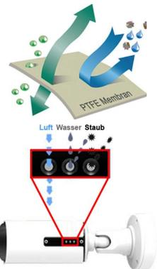
Sobald die Kamera den Betrieb startet und sich erwärmt, entfernt sich dieser Beschlag jedoch wieder. Dieser Vorgang kann je nach Höhe der Luftfeuchtigkeit circa 30 Minuten bis mehrere Stunden dauern.
